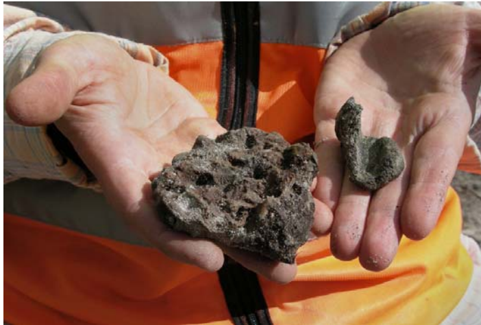
Fig. 3. På boplatserna längs Haparandabanan hittades ett omfattande metallurgiskt material i form av slagger. Slaggerna på bilden är en restprodukt som bildades då järnet smiddes ut till föremål. Foto: Olof Östlund © Norrbottens museum
