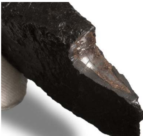
Fig. 2. Holkyxan påträffades på en av boplatserna längs Haparandabanan. I det snittade partiet syns en tydlig kärna av stål. Vid analyser har man konstaterat att yxan är uppbyggd av flera lager stål som vällts samman. Eggen har sedan härdats, dvs snabbkylts från hög temperatur, för att få ett hårdare material. För att minska på sprödheten i stålet har eggen också glödgats. Foto: Staffan Nygren © Norrbottens museum
