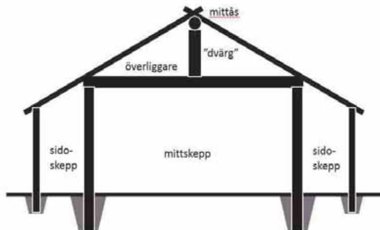
Fig. 11. Figuren visar en hypotetisk sektion genom hus I på Sockenvägen samt tillämpliga begrepp. Husets bredd är 7 meter (mittskeppet 4 m och sidoskeppen 1,5 m) och bockhöjden 2 meter i denna schematiska framställning. Stolparna tillsammans med överliggaren utgör det viktigaste konstruktionselementet, nämligen bocken. Takvinkeln är beroende av taktäckningsmaterialet och i det valda exemplet blir vägghöjden ca 1,7 m. Konstruktionsmässigt kunde "dvärgarna" bytas ut mot mesulor, men under alla omständigheter måste takvikten hämtas av centralt placerade stolpar, antingen mesulor, eller som i detta fall "dvärgar". En kombination av mesulor och "dvärgar" förekommer också.
