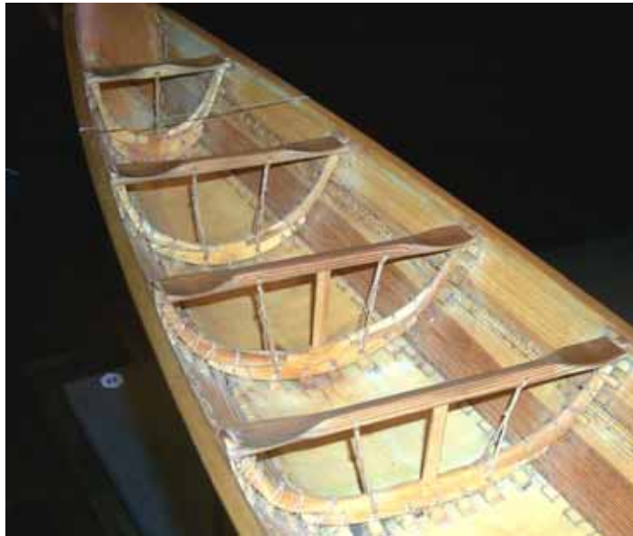
Fig. 10. Foto av den rekonstruktion som visas i utställningen vid Murberget, Läns-museet Västernorrland. Här har man låtit de två minsta tofterna fästas vid spanten av tvinnade, lodräta rep, medan de bredare tofterna därtill fått en stadgande lodrät bräda på samma sätt som fanns i hjortspringbåten. Foto: förf.
